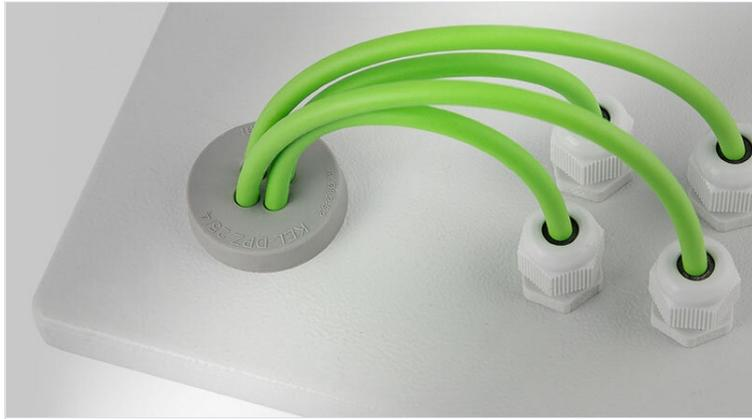
Die Kabeldurchführungsplatten KEL-DPZ rund ermöglichen es, auf engstem Raum sehr viele Leitungen, auch mit unterschiedlichen Durchmessern von 1.5 bis 22 mm einzuführen und 2-fach gemäß IP66 / IP68 / UL Type 12/4X\* abzudichten. Gleichzeitig werden die durchgeführten Leitungen zugentlastet.
